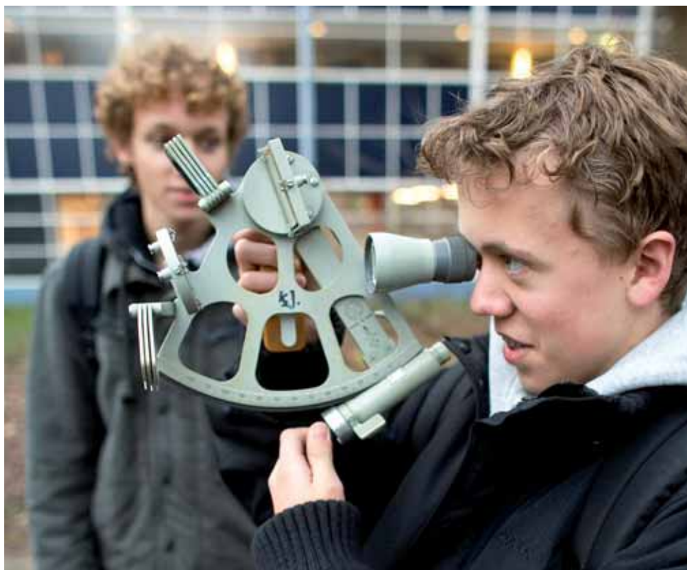
Een leerling bepaalt met een sextant de hoogte van een boom aan de hand van de stand van de zon. Foto: Voermans van Bree Fotografie.
