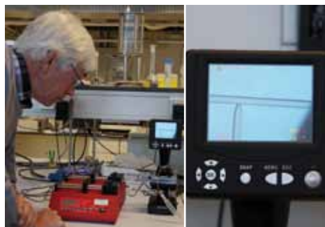
Prototype van de LoC leerlingenset met druppelchip onder microscoop.
