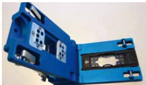
Prototype van de LoC leerlingenset met druppelchip onder microscoop.
